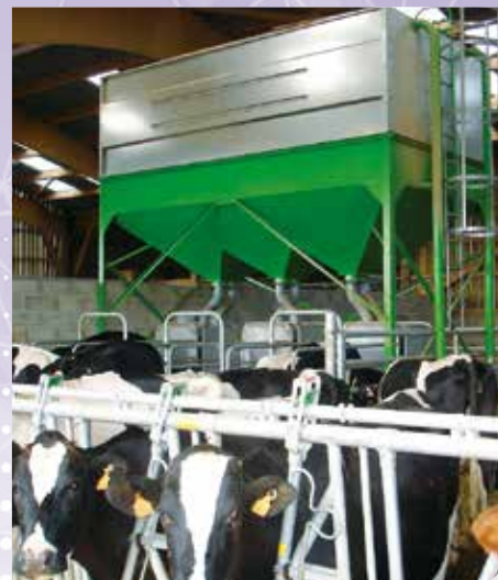
3 cônes pour 3 stations DAC en ligne
