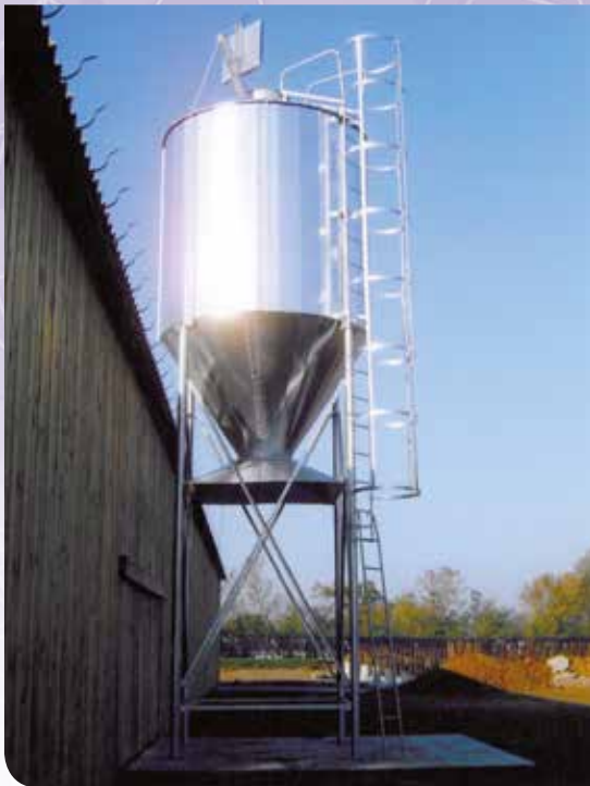
Silo tôle galvanisée
